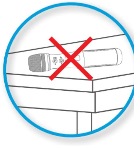
Para evitar feedback acústico (chirrido), no coloque la unidad sobre una mesa o superficie dura cuando esté encendida.
